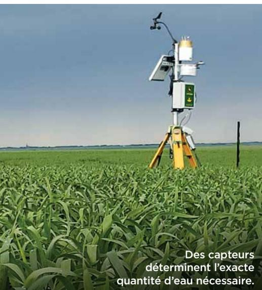
Des capteurs déterminent l'exacte quantité d'eau nécessaire.
